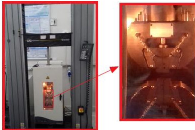
Figura 2. Máquina de ensaios universal marca INSTRON, modelo 5582, equipada com câmara térmica mostrando detalhe das garras.
